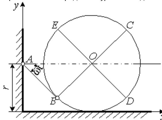
7. Стержень АВ длиной l скользит концом В по вертикальной стене, а концом А – по полу, при этом  $V_A = V = \text{const.}$  Определить уравнения движения и уравнение траектории точки М, если при  $t = 0$  стержень вертикален. Вписать правильный ответ.
