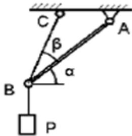
2. Груз весом  $P = 10 \text{ Н}$  подвешен на двух тросах AB и BC, составляющих с горизонтальной прямой углы  $\beta=15^\circ$  и  $\alpha=30^\circ$ . Определить усилия в тросах.
